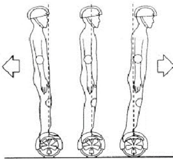
5. Чтобы маневрировать, слегка наклонитесь в ту сторону, в которую хотите повернуть. Если вы наклоните ноги в противоположных направлениях, гироскутер будет вращаться вокруг своей оси.
